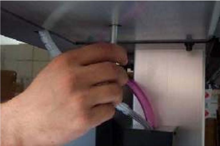
20. Insira a ponta oval do tubo do cap na parte inferior da máquina e gire para abaixar a estação de selagem.
