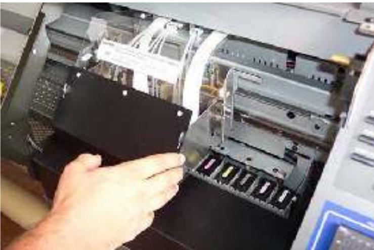
21. Desloque o carro manualmente para esquerda e certifique-se de que todo o solvente depositado no cap desceu até o frasco de descarte. Certifique-se que a espuma do cap não esta levantada.
