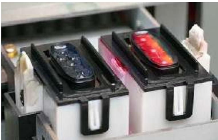
8. A seguir use uma seringa ou uma pipeta para encher as estações de selagem com solvente. Isto ajudará a limpar as partes internas das bombas de sucção de tinta.
