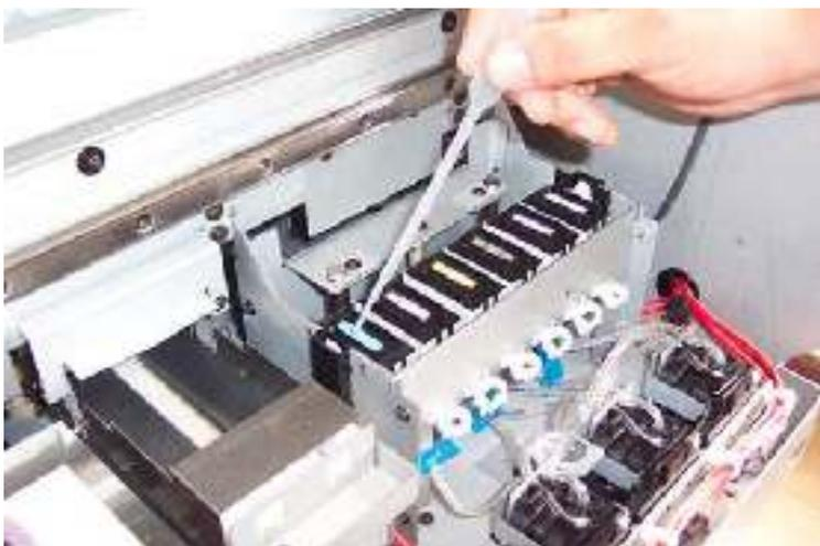
16. Use uma seringa, conta gotas ou uma pipeta para encher as estações de selagem com solvente.
