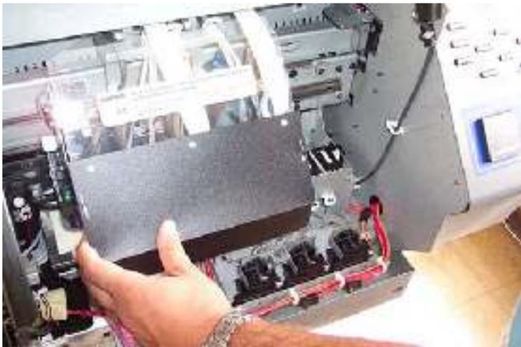
17. Desloque o carrinho das cabeças de volta para a posição de descanso, alinhando as guias da estação de selagem com as guias do carro de impressão.
