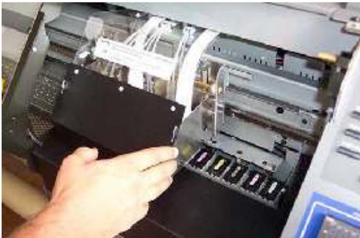
14. Desloque manualmente o carro para esquerda para ter acesso a estação de selagem.
