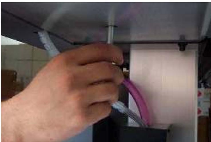
13. Coloque a tampa esquerda e pressione a tecla [ **ENTER** ]. A máquina deslocará o carrinho das cabeças de volta para a estação de selagem, bombeará o solvente e se desligará. Insira então a ponta oval do tubo do cap na parte inferior da máquina e gire até que o carrinho das cabeças possa ser movimentado.
