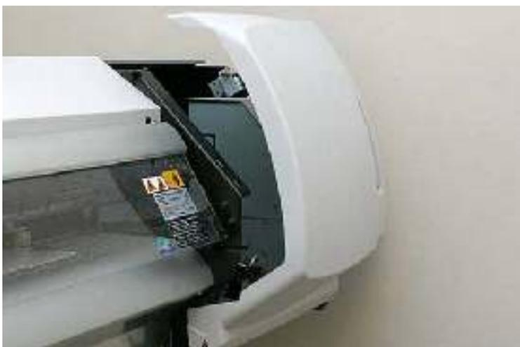
6. Uma vez terminada a limpeza das cabeças abra a tampa de proteção direita, removendo os dois parafusos de aperto.
