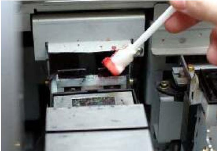
10. Use um cotonete umedecido com solvente para limpar a face frontal e traseira assim como a parte superior dos limpadores. Use a pinça para remover qualquer crosta ou resíduo. Os limpadores esfregam e limpam a parte inferior das cabeças e eles devem estar em ótimo estado para a máquina imprimir bem. Troque-os caso estiverem, deformados ou sem a borda reta. Limpe também qualquer área em volta que tenha respingos de tinta.
